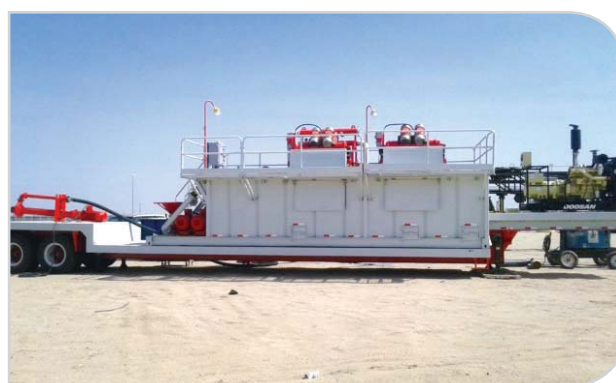
Система регенерации бурового раствора бурения водяной скважины
