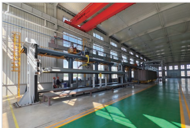
Производственная линия роботизированной сварки оборудования для контроля и разделения твердых частиц
