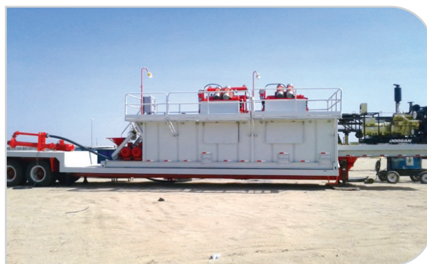
Система регенерации бурового раствора бурения водяной скважины
