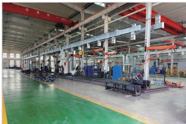
Производственная линия роботизированной сварки оборудования для контроля и разделения твердых частиц
